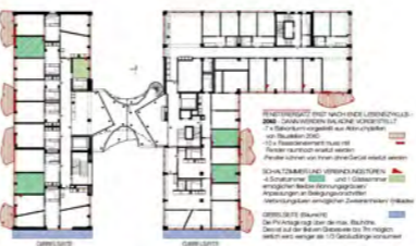
Schema Fassadenrenovierung / Schattzimmer / Baureicht 1:500
